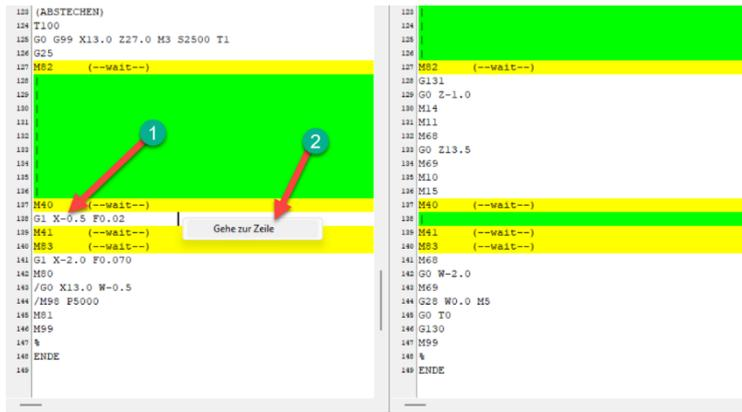
Wenn Sie den Cursor in dem Fenster(n) innerhalb der Synchronisierung platzieren (1) und mit Rechts Klick aus dem Kontextmenü „Gehe zur Zeile“ (2) anklicken, wird der Cursor im NC-Editor nach schließen des Synchronfensters dort platziert.
